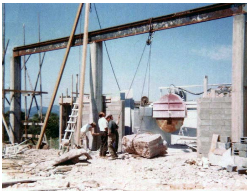
Premiers essais du disque à dents diamantées de 2 m de diamètre (photo Louis Anglade)
